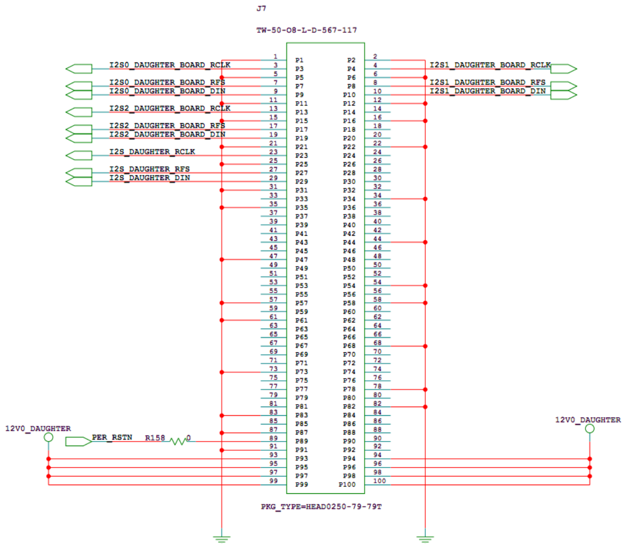
图3-5 扣板插座 J7 管脚示意图
